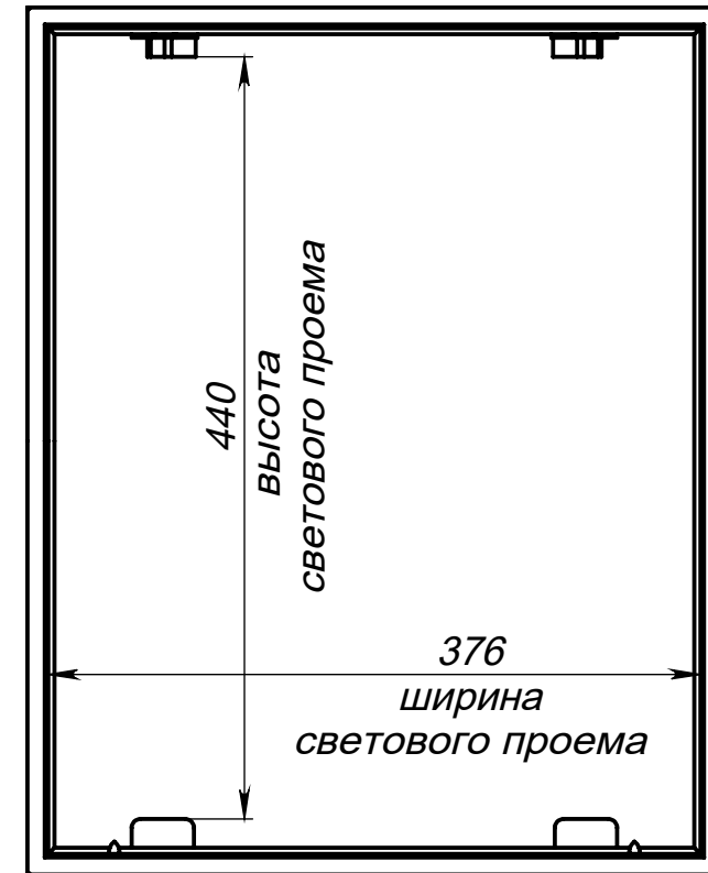
Вид спереди на люк (съемная дверь снята)
